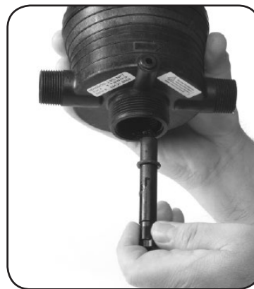
Passo 5. Substitua o O-ring N°17.
