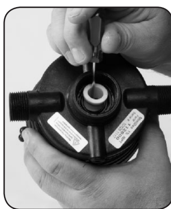
Paso 5. Reemplace el SEPARADOR DE LA JUNTA DEL EJE #83.
