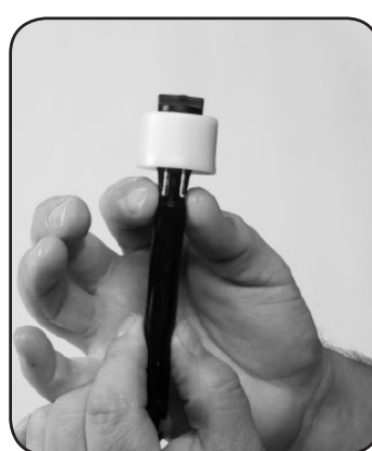
Passo 6. Aperte as orelhas do eixo e remova o PISTÃO DOSADOR n° 44.
