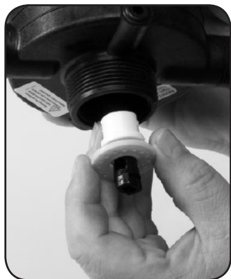
Paso 7. Reinserte del Junta de la N°16 y sellar espaciador N°17.
