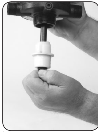
Étape 2. Twist pour déverrouiller et enlever la TIGE DE COMMANDE #52, #16 JOINT D'ÉTANCHÉITÉ et #15 MANDAT.
