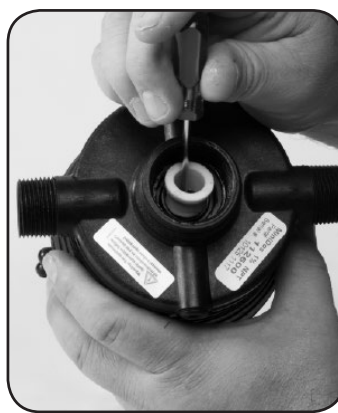
Fase 5. Sostituire lo spaziatore di guarnizioni dell'albero n.83.
