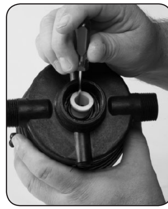
Schritt 3. Entfernen Sie den WELLENDICHTUNG ABSTANDHALTER #83.
