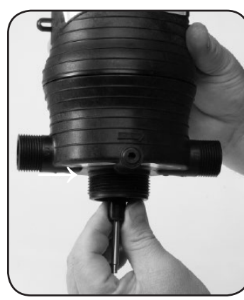
Paso 6. Después de reemplazar a 82 # sello separador y # 18 juntas, reemplazar # 52 eje superior. Gire 1/4 vuelta para bloquear en el lugar.
