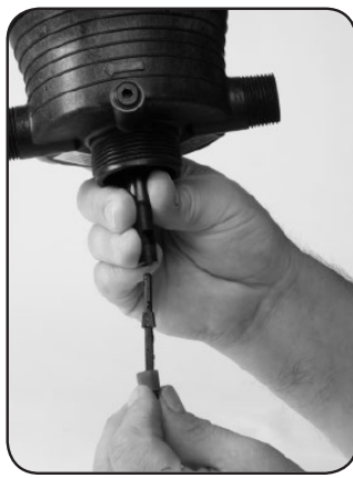
Paso 2. 1/4 a desbloquear y eliminar # 51 inferior del eje y reemplazar.
