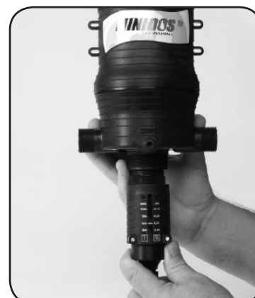
Étape 9. Revisser le CYLINDRE EXTERNE #7 sur le corps de pompe.
