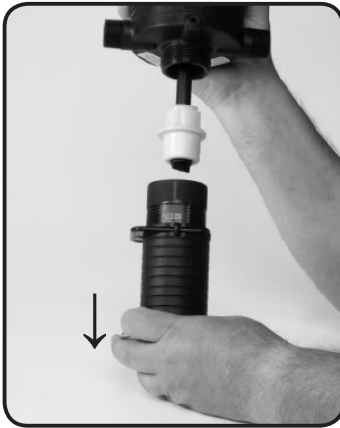
Schritt 1. Schrauben Sie den AUSSENZYLINDER #7 vom Körper ab.
