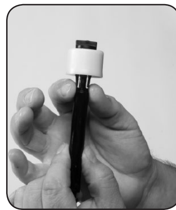
Étape 6. Appuyez sur les pattes de la tige et retirez le PISTON DOSEUR n° 44.
