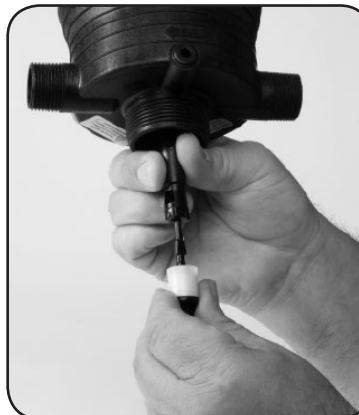
Schritt 8. Installieren Sie den unteren Schaft mit dem neuen Dosierkolben, indem Sie ihn 90° drehen bis er einrastet.
