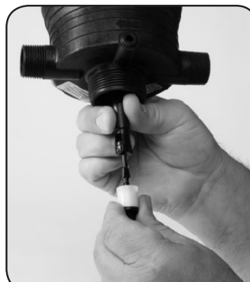
Étape 8. Réinstallez la tige inférieure avec un nouveau piston doseur en le faisant pivoter de 90° pour enclenchement complet.
