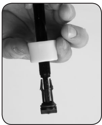
Fase 7. Riposizionare lo stantuffo di dosaggio n.44 con i bordi sottili in alto (verso la parte superiore dell'albero).
