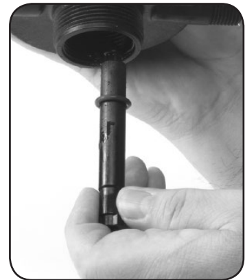
Fase 6. Reinstallare l'albero superiore n.52 e l'O-ring n.17
