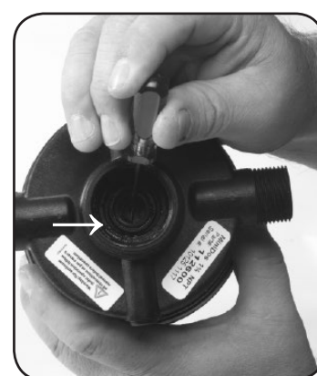
Passo 6. Substitua o anel em O no. 17.
