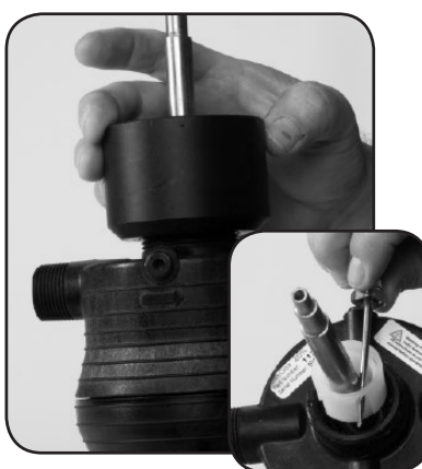
Schritt 5. Entfernen Sie den ADAPTER #72 so wie den O-Ring #68, den DICHTRINGHALTER #15 und WELLENDICHTUNG ABSTANDHALTER #83. Ersetzen Sie falls beschädigt oder abgenutzt.
