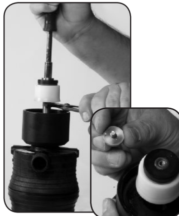
Paso 2. Giro para desbloquear y extraiga el CAPSCREW N°93.
