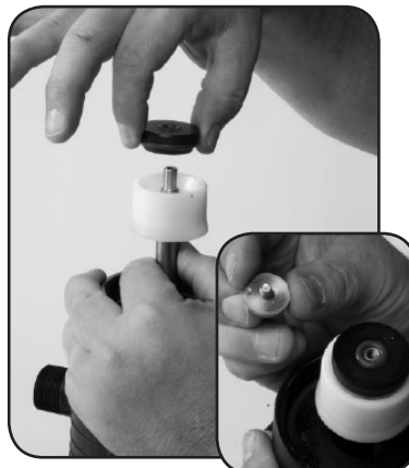
Paso 8. Reemplace la GUÍA DEL PISTÓN DOSIFICADOR #73 y el PISTÓN DOSIFICADOR #44.
