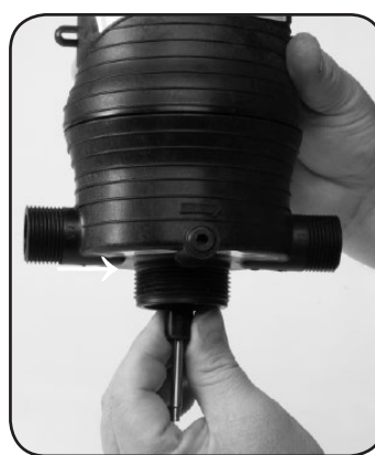
Fase 6. Dopo aver sostituito lo spaziatore di guarnizioni n.82 e la guarnizione n.18, riposizionare l'albero superiore n.52. Ruotare di 1/4 per fissarlo.
