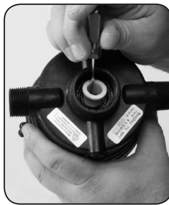
Étape 5. Remplacez RONDELLE DE JOINTURE DE LA TIGE n° 83.
