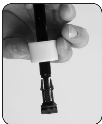
Passo 7. Substitua o PISTÃO DOSADOR n° 44 com as bordas finas voltadas para cima (em direção à parte superior do eixo).
