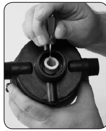
Étape 3. Retirez la RONDELLE DE JOINTURE DE LA TIGE n° 83.
