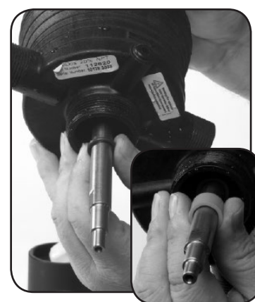
Schritt 6. Entfernen und ersetzen Sie den O-Ring #17. Installieren Sie wieder den WELLENDICHTUNG ABSTANDHALTER #83 und den DICHTRINGHALTER #15.
