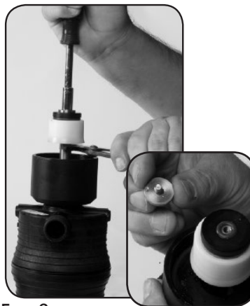
Fase 2. Svitare per sbloccare e rimuovere la vite a testa cilindrica n.93.
