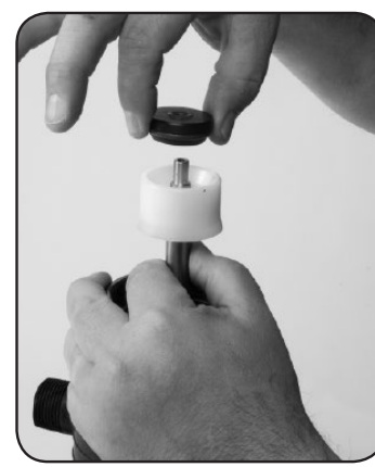
Schritt 3. Entfernen Sie die DOSIERKOLBENFÜHRUNG #73, reinigen und überprüfen Sie den O-Ring #14.
