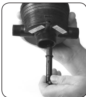
Paso 5. Reemplace el O-ring N°17.
