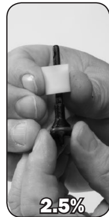
Paso 3. Reemplace el PISTÓN DOSIFICADOR #44 con las lengüetas delgadas hacia arriba. Limpie y compruebe el o-ring #14 reemplace en caso necesario.
