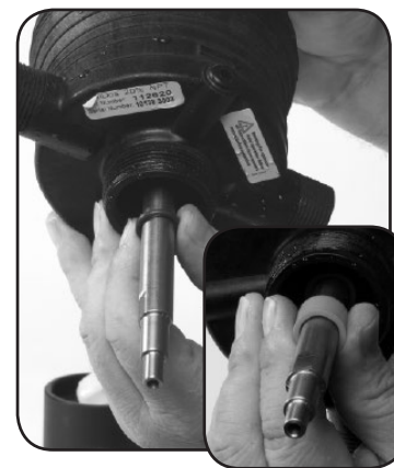
Paso 6. Retire y reemplace el o-ring #17. Reinstale el SEPARADOR DE LA JUNTA DEL EJE #83 y el RETÉN DE LA JUNTA #15.
