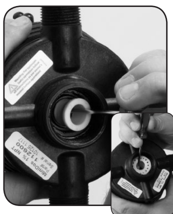
Fase 7. Sostituire lo spaziatore di guarnizioni dell'albero n.82 e la guarnizione n.16.
