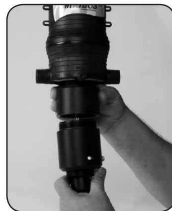
Passo 9. Aparafuse o CILINDRO EXTERNO n° 61 no corpo.
