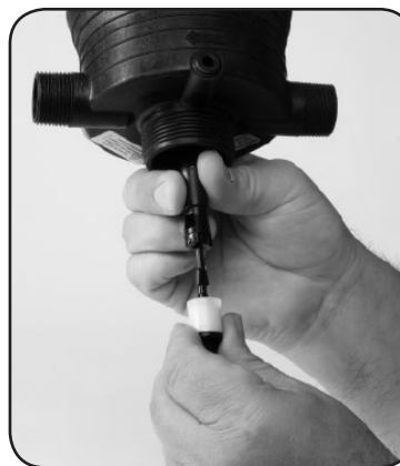
Passo 8. Reinstale o eixo inferior com o novo pistão dosador girando 90° para travá-lo no lugar.
