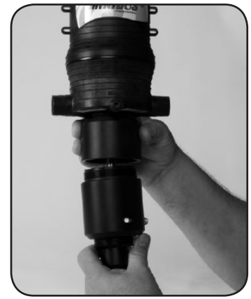
Paso 9. Enrosque el CILINDRO EXTERIOR n° 61 en el cuerpo.
