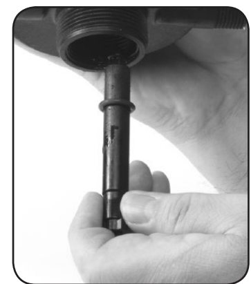
Étape 6. Réinstallez la TIGE DE COMMANDE #52, le JOINT TORIQUE #17.
