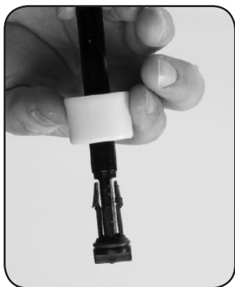
Étape 7. Remplacez le PISTON DOSEUR n° 44, les lèvres minces dirigées vers le haut (en direction de la partie supérieure de la tige).
