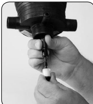
Paso 8. Reinstale el eje inferior con el nuevo pistón dosificador girando 90° para que quede en su lugar.
