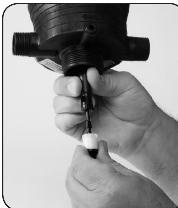
Fase 8. Reinstallare l'albero inferiore con un nuovo stantuffo di dosaggio ruotandolo di 90° per bloccarlo.
