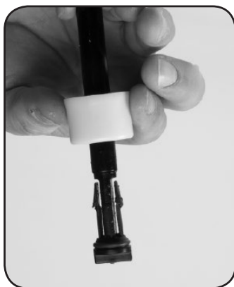
Schritt 7. Ersetzen Sie den DOSIERKOLBEN #44, dünne Lippen aufwärts (in Richtung Schaft).
