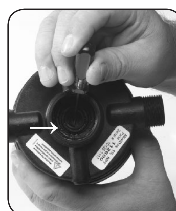
Fase 6. Sostituire l'O-ring n.17
