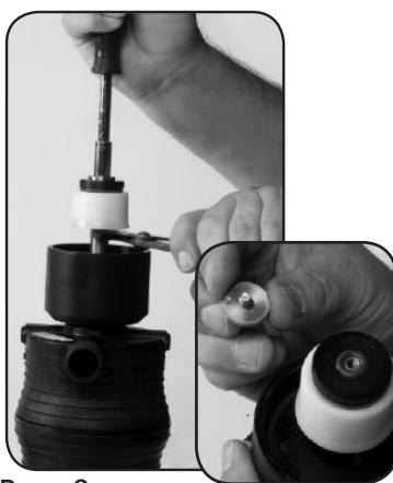
Passo 2. Torcer para desbloquear e CAPSCREW N°93.
