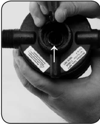
Étape 4. Retirez le joint torique n° 17 et remplacez.
