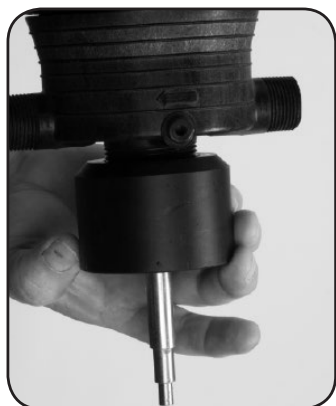
Étape 7. Reset # 68 joint torique et vis # 72 adaptateur sur corps.
