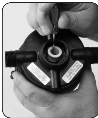
Schritt 5. Ersetzen Sie den WELLENDICHTUNG ABSTANDHALTER #83.
