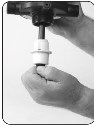
Fase 2. Ruotare di 1/4 e rimuovere l'albero n.52, la guarnizione n.16 e il dispositivo di tenuta n.15
