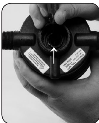
Passo 4. Remove o anel O-ring n° 17 o substitua.
