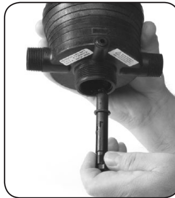
Schritt 5. Ersetzen Sie den O-ring #17.
