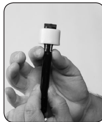
Schritt 6. Drücken Sie die Laschen am Schaft und entfernen Sie den DOSIERKOLBEN #44.
