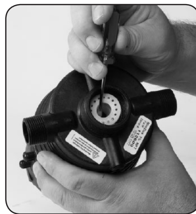
Schritt 3. Remove #16 Gasket.
