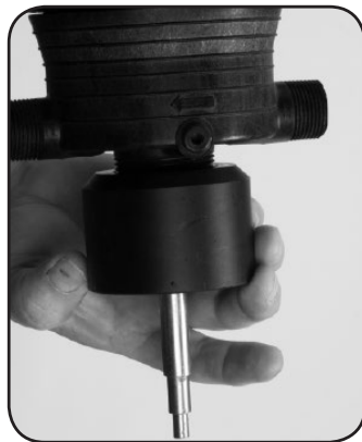
Paso 7. Coloque el o-ring n°68 y enrosque el ADAPTADOR n°72 en el cuerpo.
