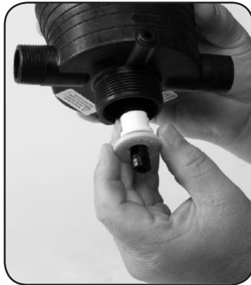
Schritt 4. Entfernen Sie den Reinigen sie die dichtungen #16 und #82.
