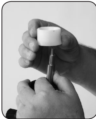
Paso 4. Retire el PISTÓN DOSIFICADOR #44.
