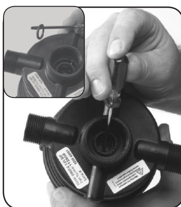
Passo 5. Troque o anel em O no. 17.
