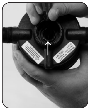
Paso 4. Retire el O-ring #17 y reemplace.
