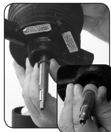
Passo 6. Remove e substitua o anel "O" n° 17. Reinstale o ESPAÇADOR DA VEDAÇÃO DO EIXO no 83 e o RETENTOR DA VEDAÇÃO no 15.
