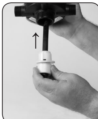
Paso 8. Reemplace el eje N°52, JUNTA DE LA N° 16 y RETENEDOR N° 15.
