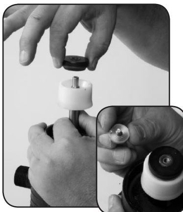
Passo 8. Substitua o GUIA DO PISTÃO DOSADOR n° 73 e o PISTÃO DOSADOR n° 44.
