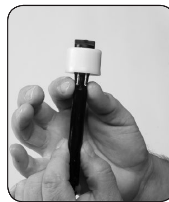
Fase 6. Schiacciando i lati dell'albero rimuovere lo stantuffo di dosaggio n.44.
