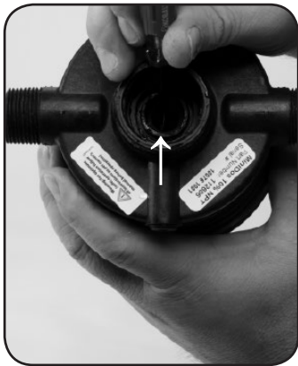
Fase 4. Rimuovere l'O-ring n.17 e sostituirlo
